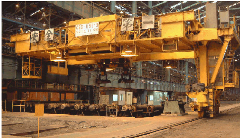
Fig.2: Ein Halbportalladekran mit Laser-Positioniergerät
