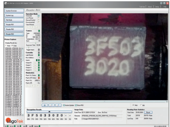
Bild 2. Das Framework mit Optical Character Recognition, Kamera-steuerung, Kontroll-, Kommunikations- und Archivierungsfunktionen
