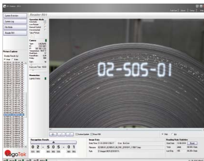
Das IPA-Framework von LogoTek mit OCR, Kamera-Steuerung, Kontroll-, Kommunikations- und Archivierungsfunktionen
